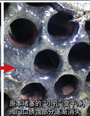
原本堵塞的“小孔”变干净，阀门口锈蚀部分逐渐消失
